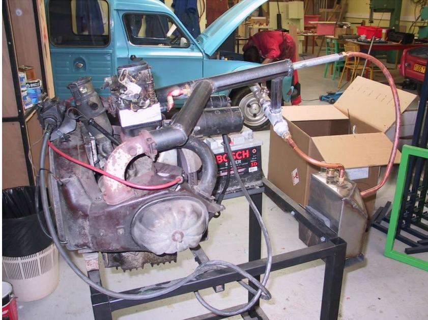
Le montage sur banc du moteur avec le réacteur Pantone terminé.
