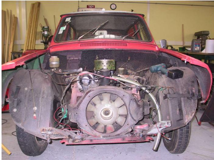
La dépose du moteur nécessite de démonter tout l'avant de la voiture. C'est une opération très longue sur AMI 6.
