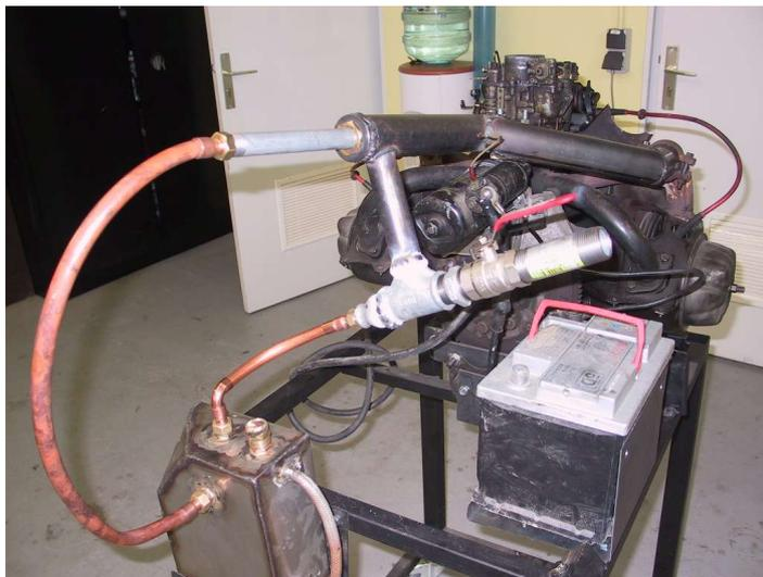
Le moteur monté sur banc avec la batterie, le bulleur, le réacteur.
